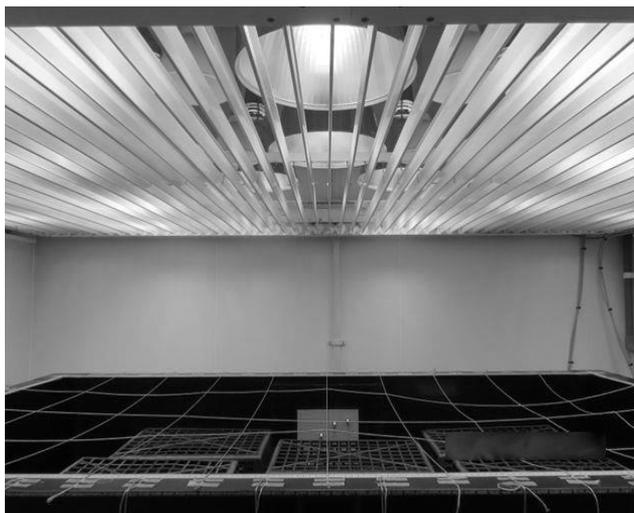
図 3 模擬太陽光照射装置(神奈川大学湘南ひらつかキャンパス 12 号館に設置)
