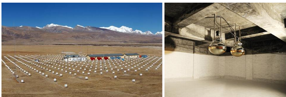
図 1 チベット高原・標高 4300m に設置されている空気シャワー観測装置(左)とその地下に設置されている注水前の水チェレンコフ型ミューオン検出器(右)。
