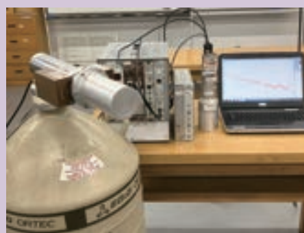
ガンマ線検出システム
