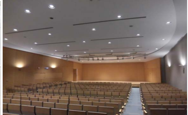
横浜キャンパス 16号館セレストホール LED照明設置 0~100%の調光が可能
