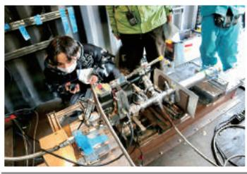
多いときで2週に1度、燃焼実験をしている。ハイブリッドロケットは、学生でも扱えるような、安全な固形燃料と液体酸化剤を使用していることが最大の特徴だ
