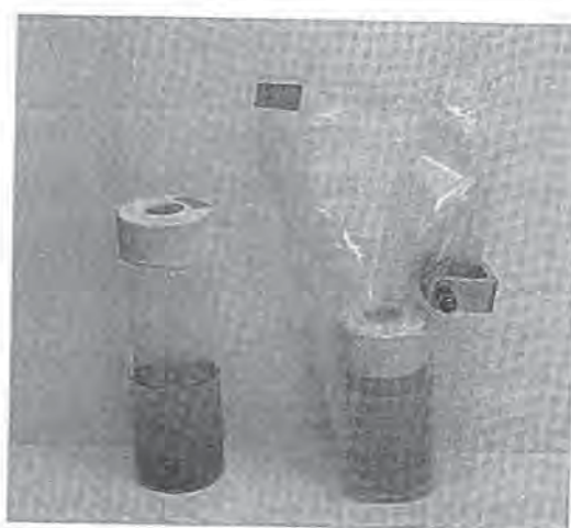
図5 密閉ガラス容器とプラスチックバッグでの水素生産の比較 左: プチルゴム中栓を付けた密閉ガラス容器。右: ガスサンプリングポートを付けたプラスチックバッグ。実験開始時の気相体積は等しい。
