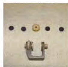
ガスの経時的サンプリング用ポート
