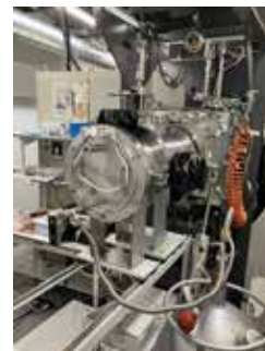
液体窒素温度(-196℃)における200kVイオンビーム照射実験装置のビーム照射部。微弱な発光も分光することができ、主に暗黒物質探索に関する実験に使用しています。
